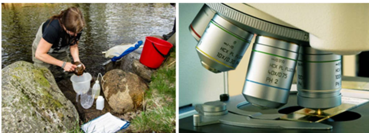
Figur 72. Provtagning av kiselalger görs i första hand genom borstning av stenar, varefter kiselalgspreparat framställs och analyseras i ljusmikroskop med 1000 gångers förstoring (objektiv 100x), © Medins Havs och Vattenkonsulter AB.
