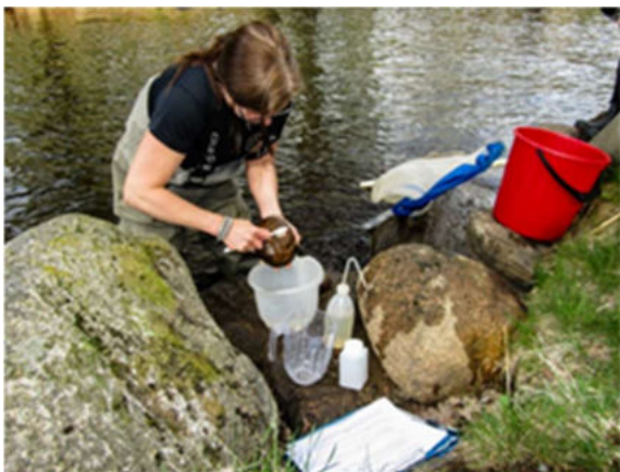
Provtagning av kiselalger genom borstning av stenar (foto: Medins Havs och Vattenkonsulter AB).
